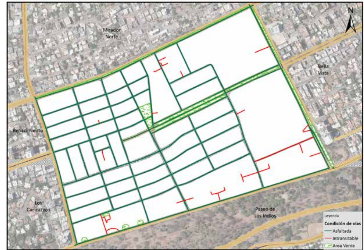
Vías en Mirador Sur según condición, 2015.
